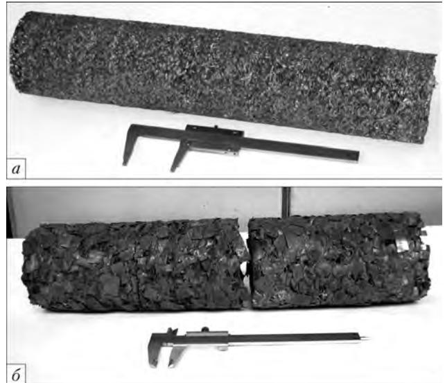
Рис. 4. Заготовки, скомпактированные из 100 % мелкой стальной стружки стали ШХ15СГ (а) и крупной стружки жаропрочного сплава ЭП609-Ш (б)
