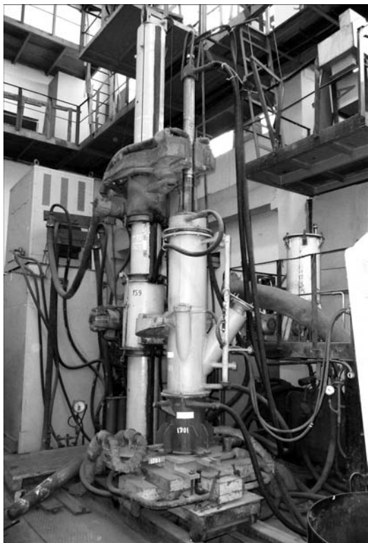
Рис. 1. Камерная печь ЭШП, изготовленная на базе установки У-578
