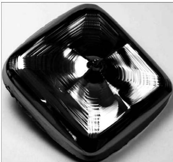
Рис. 4. Монокристалл кремния, выращенный способом Степанова [12]
