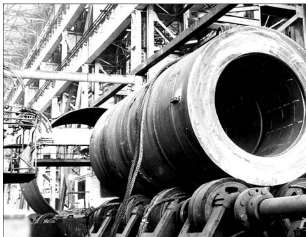
Рис. 11. Электрошлаковая сварка корпуса транспортного контейнера ТК10 из толстостенных обечайек с припаянной нержавеющей футеровкой
