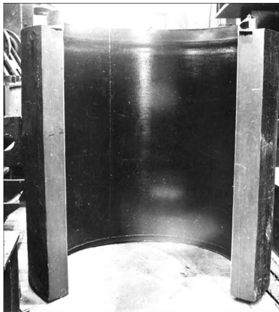
Рис. 10. Обечайка толстостенного сосуда с плакировкой из нержавеющей листа, припаянного АВП
