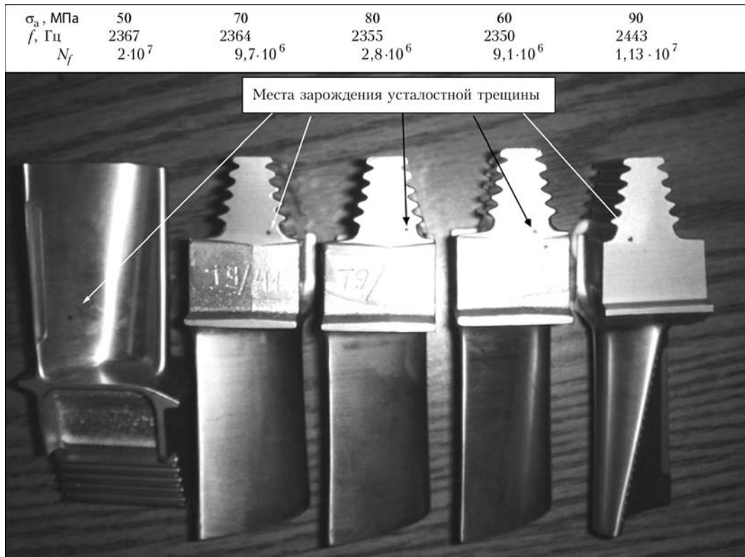
Рис. 4. Места зарождения усталостного разрушения в пяти монокристаллических рабочих лопатках турбины двигателя, не прошедших УМШ после циклических испытаний при температуре 20 °С
