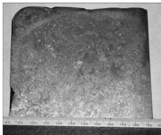
Рис. 5. Макроструктура поперечного сечения квадратного слитка стали ЭП609-Ш плазменно-дугового переплава в проходной кристаллизатор
