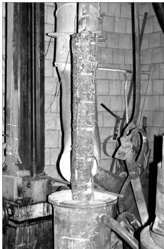
Рис. 3. Электрошлаковый переплав спрессованных электродов
