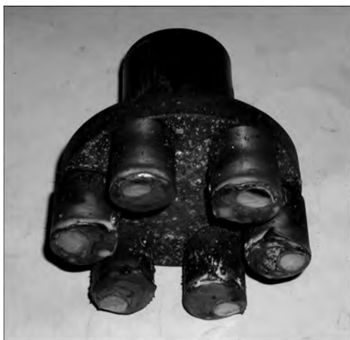
Рис. 2. Внешний вид расходоуемого электрода после плавки
