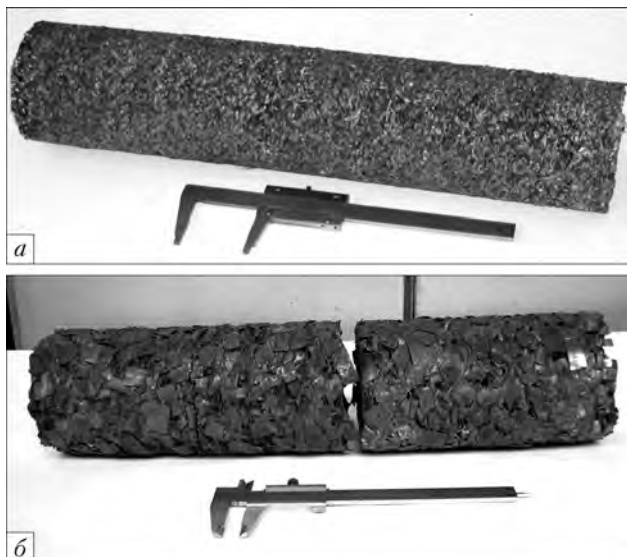
Рис. 4. Заготовки, скомпактированные из 100 % мелкой стальной стружки стали ШХ15СГ (а) и крупной стружки жаропрочного сплава ЭП609-Ш (б)
