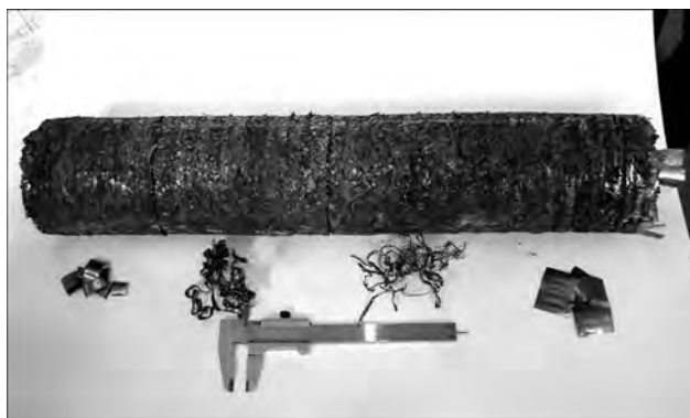
Рис. 2. Заготовка, полученная из титановой стружки различных видов
