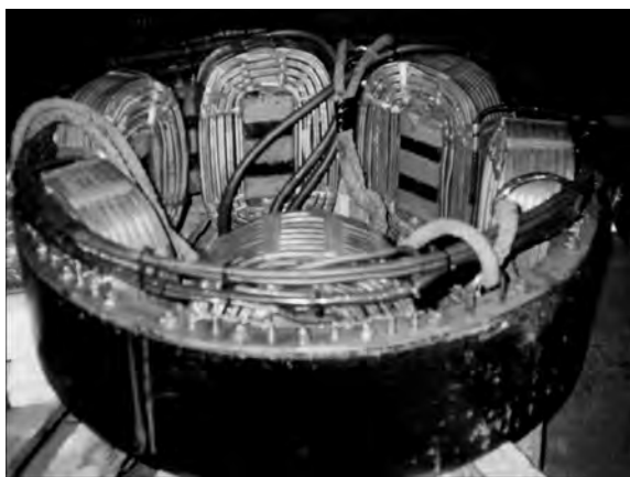
Рис. 5. Внешний вид МГД перемешивателя с вращающимся магнитным полем [8]
