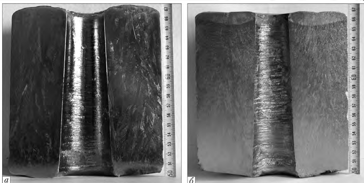
Рис. 6. Макроструктура полых титановых слитков, выполненных без (а) и с электромагнитным воздействием (б)
