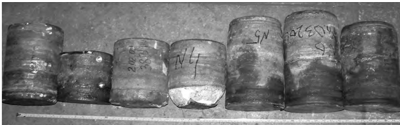
Рис. 4. Внешний вид опытно-промышленной партии слитков из нержавеющей стали, выплавленных из спрессованных электродов
