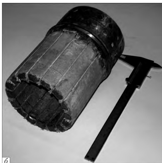
Рис. 3. Секционный скользящий кристаллизатор диаметром 80 мм для ИПСК: а — общий вид; б — формирующая секционная гильза
