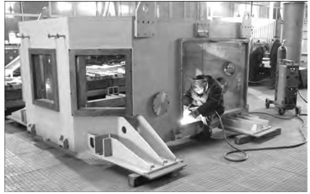
Рис. 6. Сварка камеры плавки печи ВТ02
