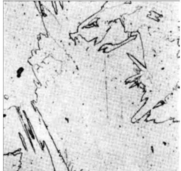
Рис. 3. \alpha' -фаза в техническом титане, \times 300
