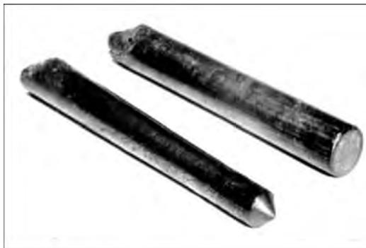
Рис. 2. Внешний вид слитков карбидов вольфрама WC-W<sub>2</sub>C, полученных способом выплавки в печи Таммана
