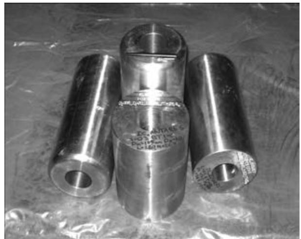
Рис. 4. Полые слитки, подготовленные для прессования
