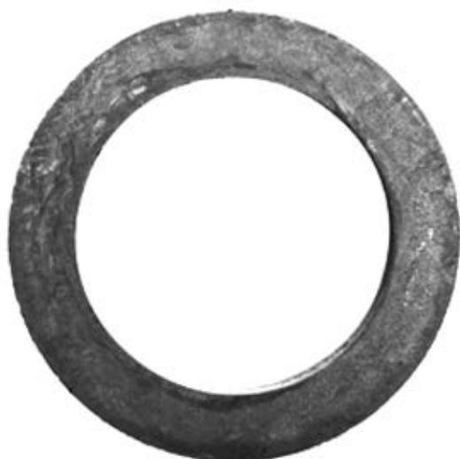
Рис. 6. Макроструктура горячепрессованной трубы диаметром 82x14 мм
