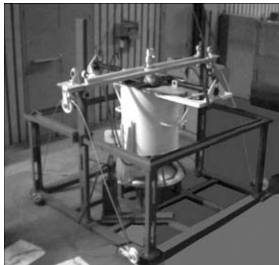
Рис. 20. Модуль для соединения разрушенных труб скважин
