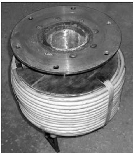
Рис. 1. Кристаллизатор с водоохлаждаемым магнитным контуром
