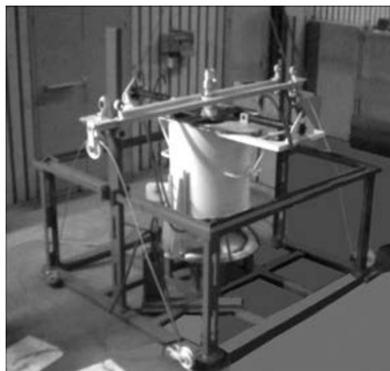
Рис. 20. Модуль для соединения разрушенных труб скважин
