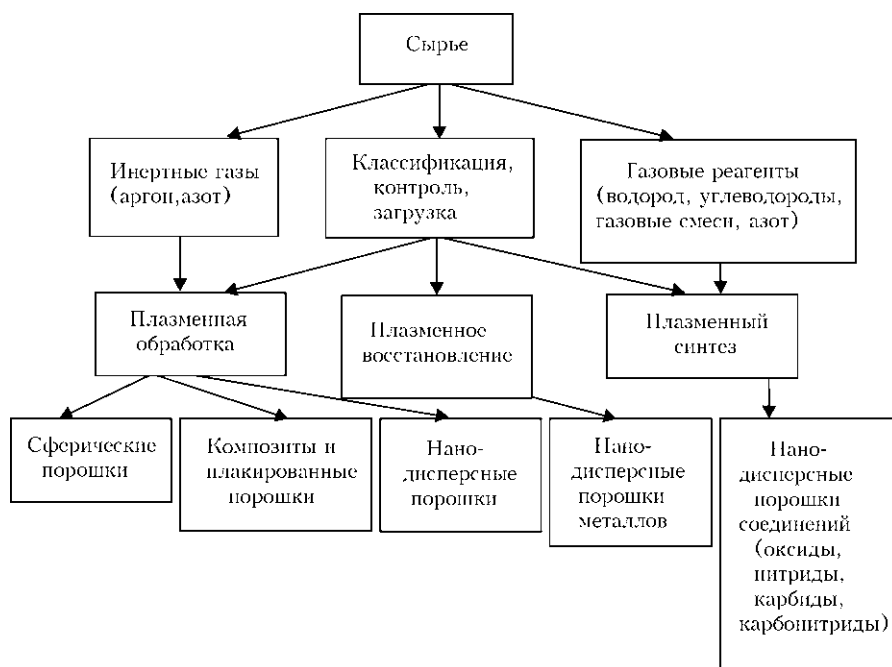
Рис. 4. Схема плазменной технологии производства порошков
