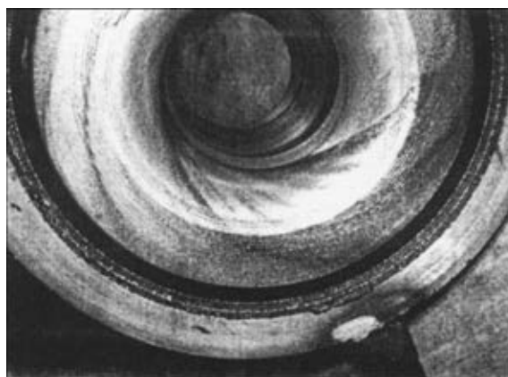
Рис. 6. След от вихревого пристеночного потока, оставленный влажным загрязненным воздухом на выходе из направляющего кольцевого зазора напорного коллектора и в сопле модели плазмотрона
