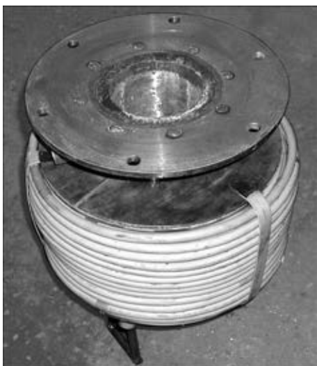
Рис. 1. Кристаллизатор с водоохлаждаемым магнитным контуром
