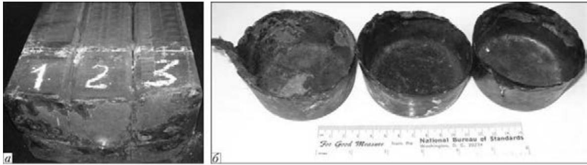
Рис. 3. Внешний вид расходимого электрода (пакет сваренных прутков) с оплавленным торцом (а), а также пробы жидкого металла типа «чашечка» при ЭШН ЖМ (б)
