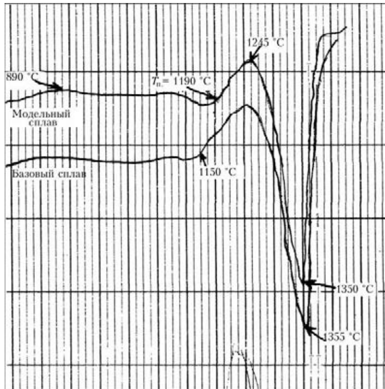
Рис. 1. Значения температуры основных фазовых превращений ( T_S , T_L , T_{п.р} ) модельного (1,5 % рения и 1,5 % тантала) и базового сплавов
