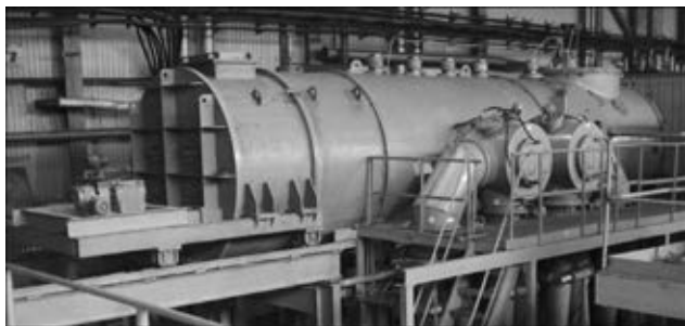
Рис. 2. Внешний вид универсальной многоцелевой электронно-лучевой установки УЭ-5810
