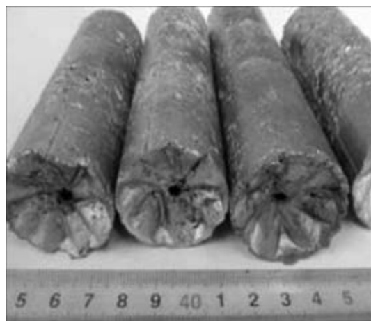
Рис. 4. Блоки из титановой губки с запрессованным в осевые отверстия порошком углерода
