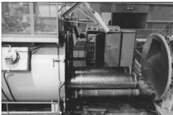
Рис. 1. Слитки диаметром 400 мм, оплавленные в электронно-лучевой установке УЭ-185
