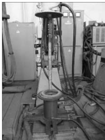
Рис. 5. Камерная электрошлаковая печь на базе аппарата А-550
