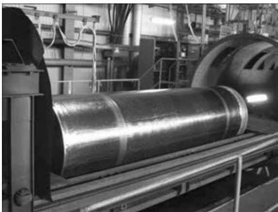
Рис. 3. Слиток диаметром 840 мм, оплавленный в электронно-лучевой установке УЭ-5810
