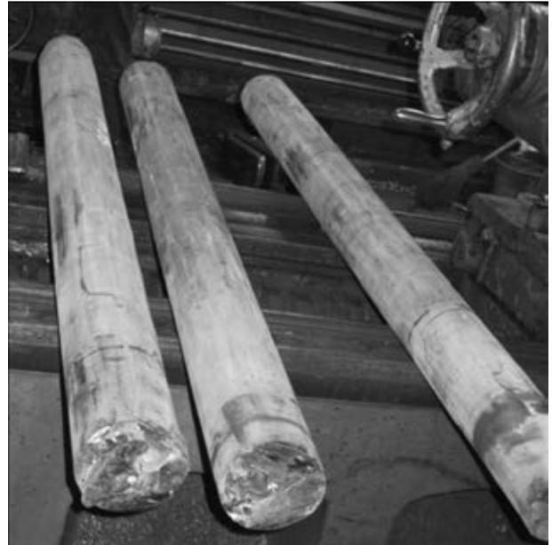
Рис. 4. Кованые прутки из титанового сплава ВТ14 диаметром 200 мм
