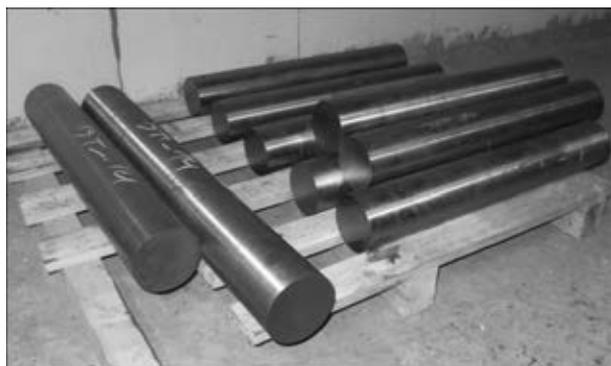
Рис. 6. Механически обработанные кованные прутки из титанового сплава ВТ14 диаметром 190 мм
