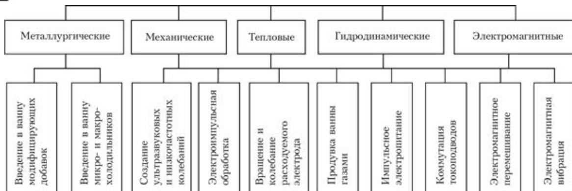
Рис. 1. Способы воздействия на кристаллизацию металла слитков при ЭШП
