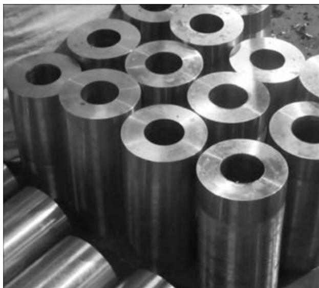
Рис. 7. Трубные заготовки из титанового сплава ВТ14 диаметром 190/90 мм
