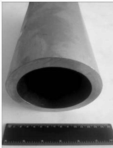
Рис. 9. Труба горячепрессованная диаметром 120×15×2500 мм после механической обработки
