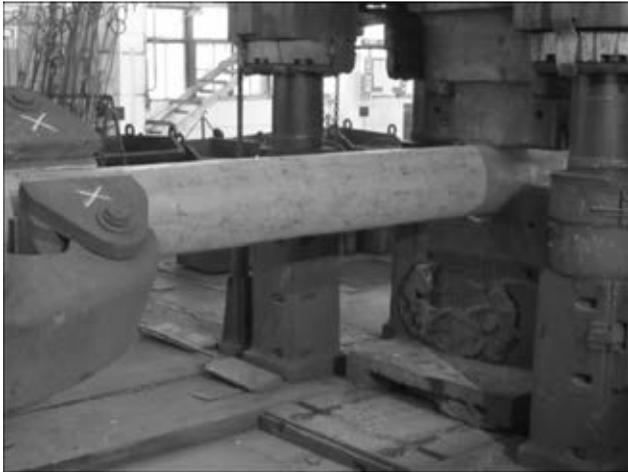
Рис. 3. Процесс ковки слитка сплава титана ВТ14
