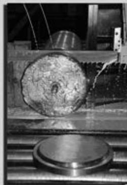
На участке механической обработки титановых слитков ООО «Запорожский титано-магниевый комбинат» завершается комплектация оборудования, необходимого для обеспечения производственного процесса. Установлены обновленные токарные станки для обработки титановых слитков, а также ленточношлифовый станок для торцевания титановых слитков и слябов (обрезки их верхней, головной и нижней частей).
