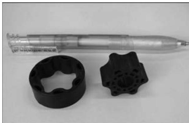
Рис. 7. Изделия, изготовленные с помощью пресс-форм из пластмассы, упрочненной углеродными волокнами
