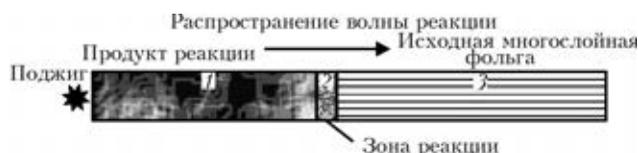
Рис. 6. Схема реализации реакции СВС в многослойной реакционной фольге: 1 — после прохождения реакции; 2 — фронта реакции; 3 — непрореагировавшая или частично прореагировавшая фольга
