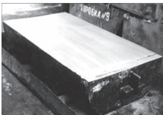
Рис. 3. Внешний вид поперечного сечения пятитонного слитка, отлитого в печи ЭШП-10Г
