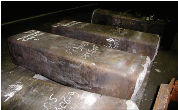
Рис. 20. Слитки из стали 08X18H10T-III сечением квадрат 565 мм и массой 4,3 т
