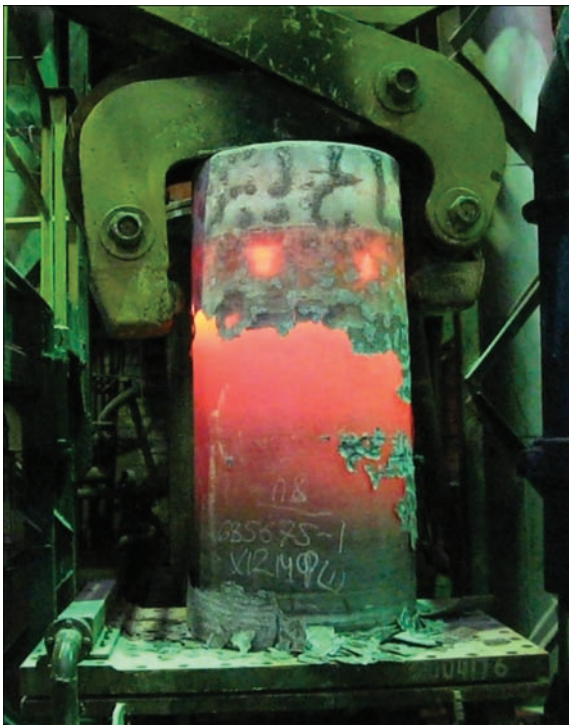
Рис. 18. Слиток из стали X12MF-III диаметром 800 мм и массой 6 т
