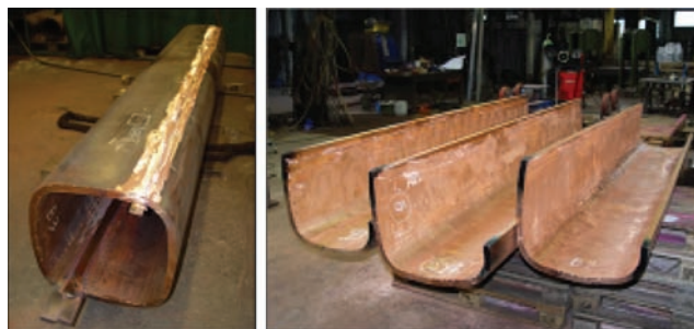
Рис. 2. Кристаллизаторы, изготавливаемые по обычной технологии прямоугольного сечения
