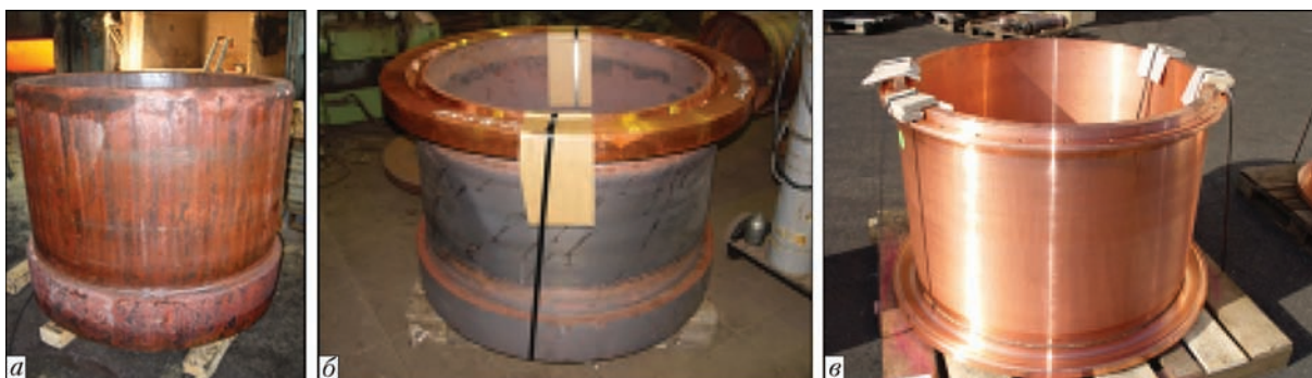
Рис. 9. Кокили для ЭШП: а — с прикованным фланцем; б, в — цельнокованные
