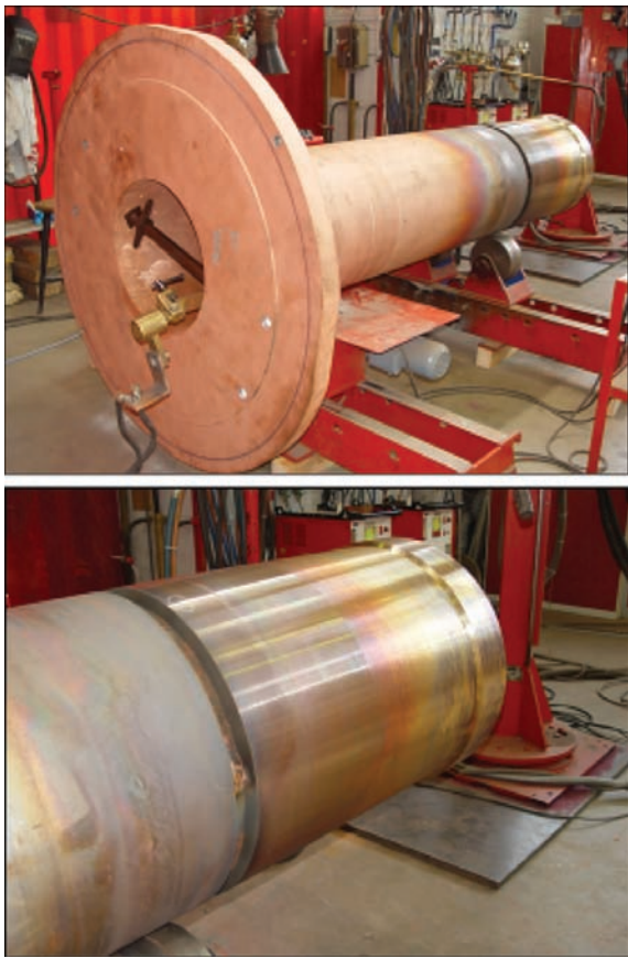
Рис. 15. Ремонт кокилей путем увеличения корпуса (удлинения)
