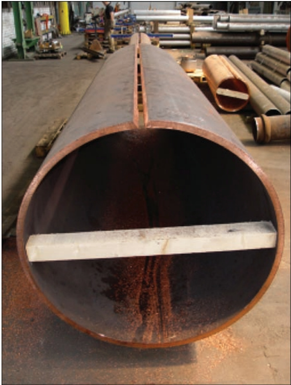
Рис. 1. Корпус кристаллизатора готовый для сварки
