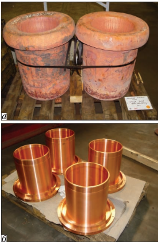
Рис. 13. Бесшовные кованные кристаллизаторы для ЭЛП (а, б — см. в тексте)
