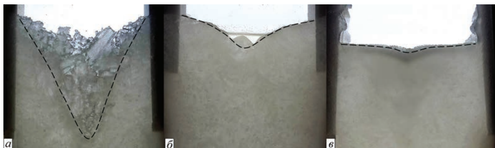
Рис. 7. Структура головной части модельных кузнечных слитков: а — без ЭШО; б — с ЭШО; в — с ЭШО и подпиткой
