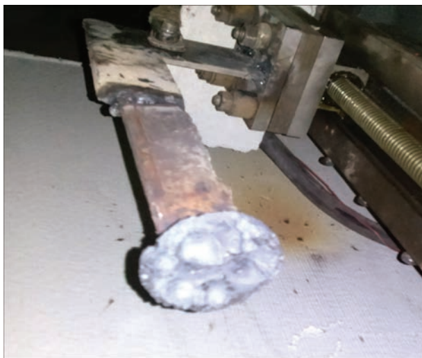
Рис. 1. Вид торца переплавляемой металлической заготовки заготовленных между собой кусков металла. И только использование флюса АН-295 обеспечило формирование переплавляемого металла в виде слитка. Поэтому в дальнейшем для осуществления процесса ЭШП в неохлаждаемой форме на низких скоростях плавки использовали флюс АН-295.
