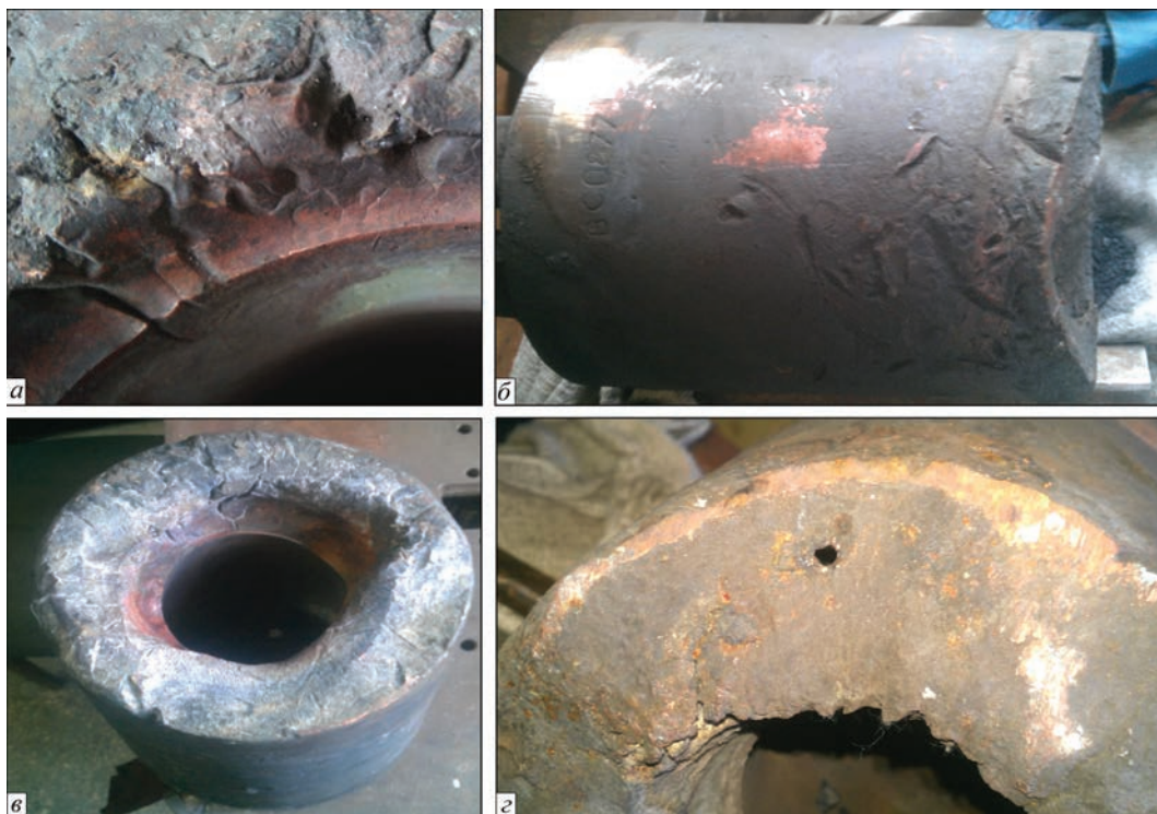
Рис. 2. Внешний вид дефектов медных камер после эксплуатации: а — сетка глубоких трещин; б — следы от механического воздействия; в — локальное выгорание меди на торцевой части камеры; г — сквозные прожоги стенки водоохлаждающих каналов
