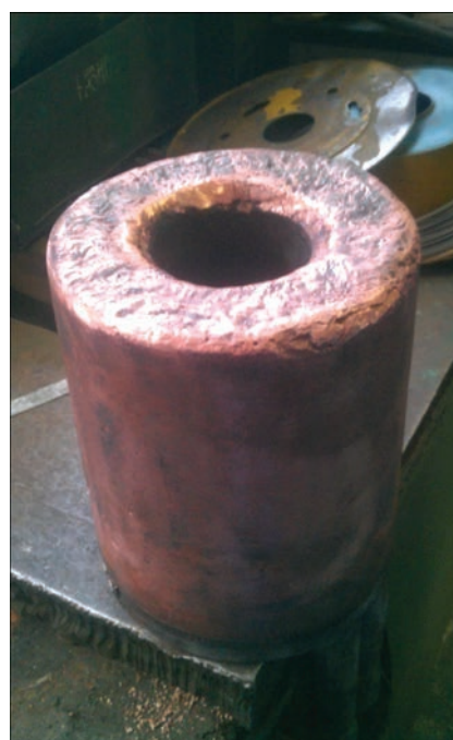
Рис. 6. Внешний вид восстановленной камеры ДСП
