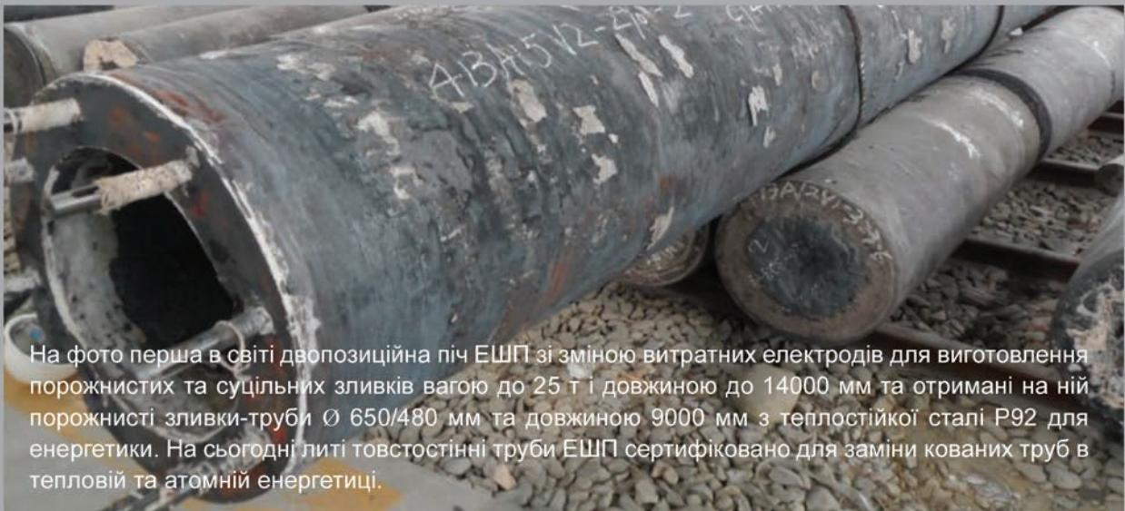
На фото перша в світі двопозиційна піч ЕШП зі зміною витратних електродів для виготовлення порожнистих та суцільних зливок вагою до 25 т і довжиною до 14000 мм та отримані на ній порожністі зливки-труби  $\varnothing$  650/480 мм та довжиною 9000 мм з теплостійкої сталі Р92 для енергетики. На сьогодні литі товстостінні труби ЕШП сертифіковано для заміни кованих труб в теплової та атомній енергетиці.
