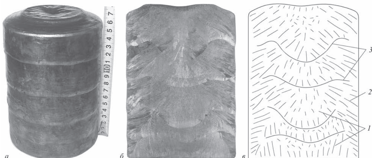
Рис. 4. Внешний вид (а), макроструктура (б) и схема кристаллизации (в) слитка сплава 29НК (плавка 3): 1 — зоны вертикально ориентированных кристаллов; 2 — зона горизонтально ориентированных кристаллов; 3 — линии сплавления
