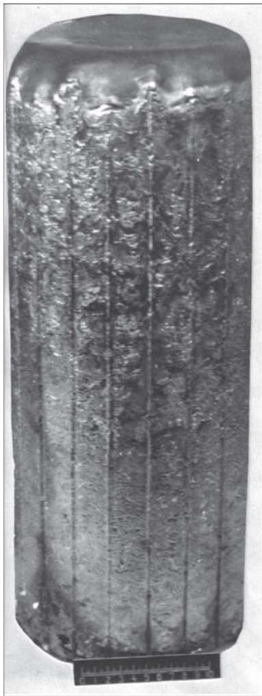
Рис. 3. Внешний вид слитка ИПСК из титанового сплава ОТ4-2 диаметром 225 мм
