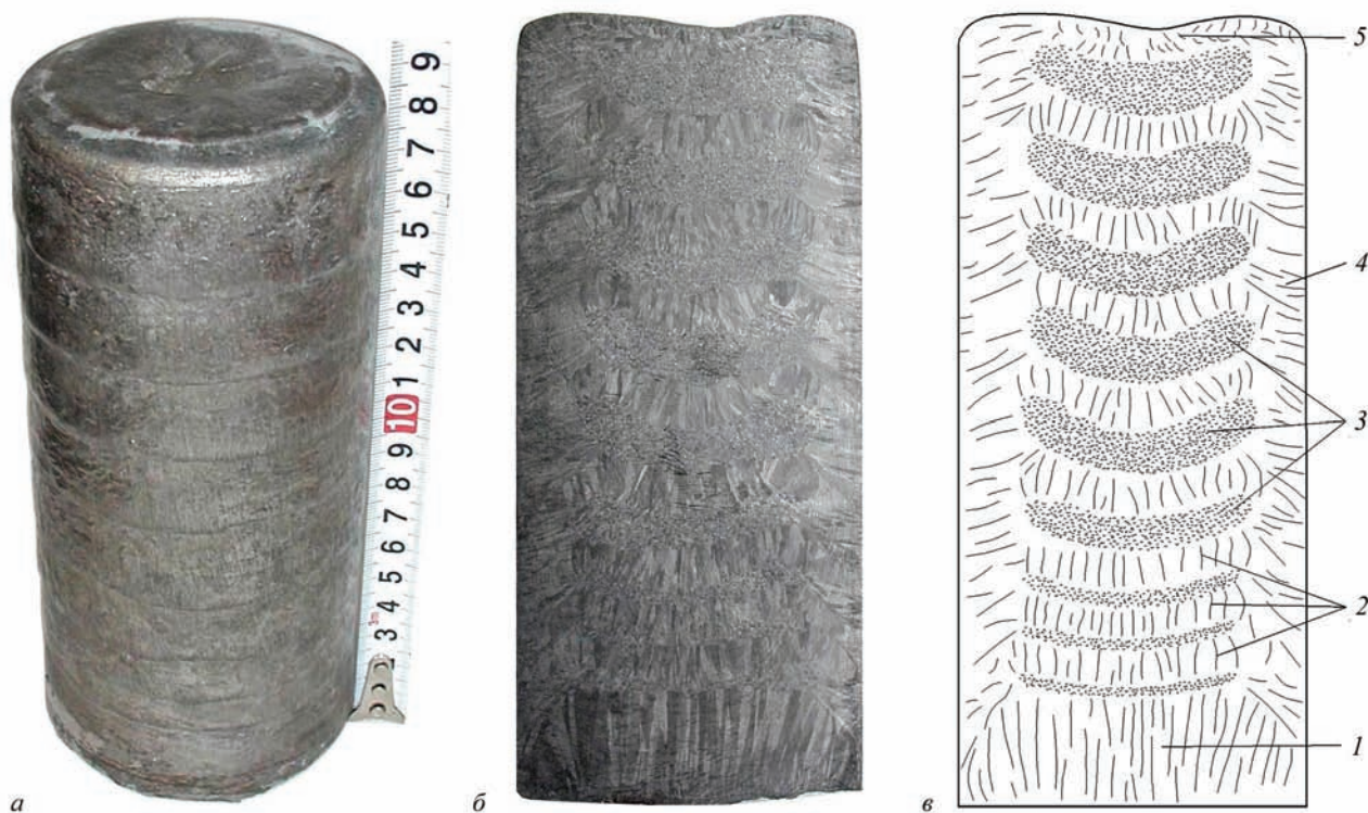
Рис. 3. Внешний вид (а), макроструктура (б) и схема кристаллизации (в) слитка сплава 29НК (плавка 2): 1 — придонная зона вертикально ориентированных кристаллов; 2 — зоны вертикально ориентированных кристаллов в центральной части слитка; 3 — зоны с мелкозернистой равноосной структурой; 4 — зона горизонтально ориентированных кристаллитов у боковой поверхности слитка; 5 — зона разориентированных кристаллов в головной части слитка
