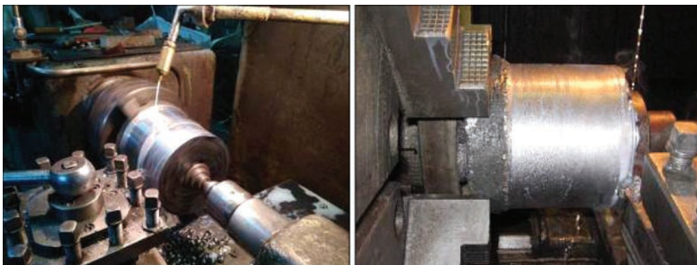
Рис. 6. Процес токарної обробки поверхневого шару зливків заліза діаметром 200 мм
