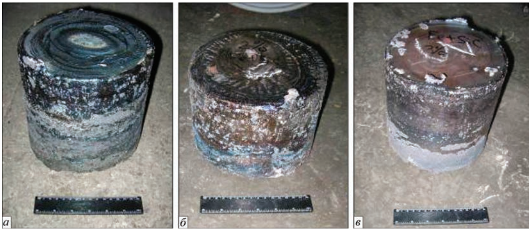
Рис. 5. Зовнішній вигляд виплавлених зливків діаметром 200 мм заліза з додаванням нанорозмірного порошку SiC, %: a — 1; б — 2; в — 3
