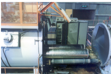
Електронно-променева установка UE185 для оплавлення поверхні зливків
