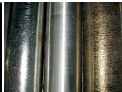
Поверхня зливків титану: оплавлена; механічно оброблена; лита
