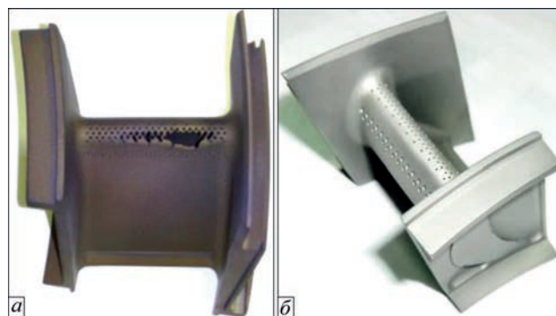
Рис. 7. Загальний вигляд соплової лопатки після напрацювання з розгаром на вхідній кромці (а) та після відновлення для подальшої експлуатації (б)
