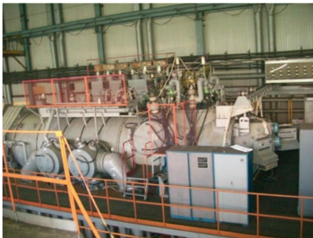
Електронно-променева установка для виплавки титанових зливок діаметром до 1100 мм та масою до 20 т
