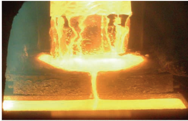
Виплавка зливка-сляба 165×950×2500 мм титанового сплаву ПТ-3В
