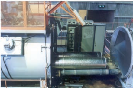
Електронно-променева установка UE185 для оплавлення поверхні злиwkів
