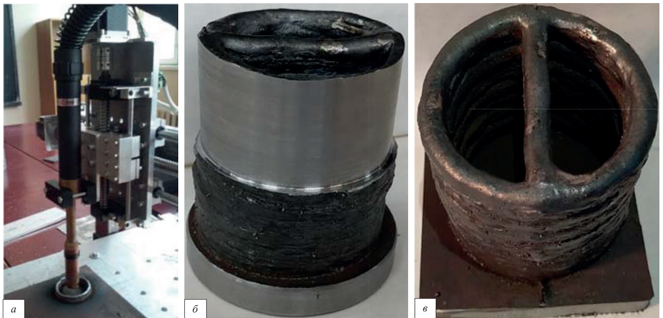
Рис.2. Головка (а) з плавким електродом для адитивного вирощування деталей із внутрішніми ребрами жорсткості (б, в)
