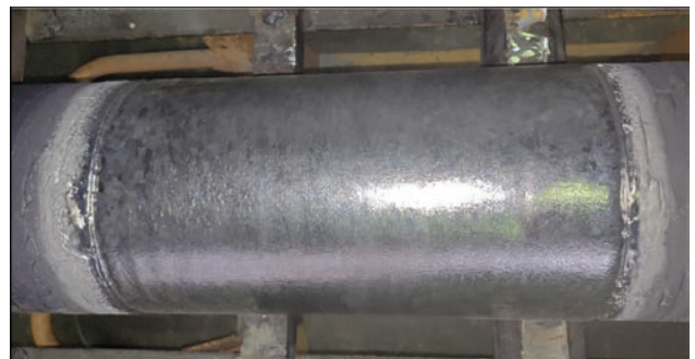
Рис. 6. Злинок ніобію з фрагментом поверхні, оплавленої електронним променем
