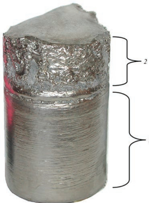
Рис. 1. Титановий зливок діаметром 65 мм, виплавлений без (1) та з використанням (2) поздовжнього магнітного поля індукцією 0,25 Тл
