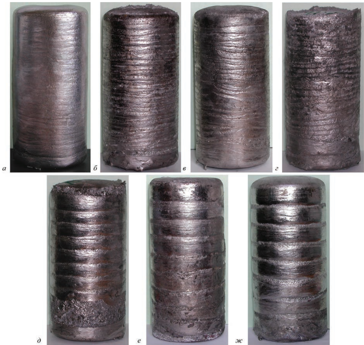
Рис. 3. Зовнішній вигляд титанових зливок, виплавлених ЕШП з використанням поздовжнього імпульсного магнітного поля: a — B = 0,24 Тл, t_{\text{імн}} = 0,3 с, t_{\text{п}} = 10 с; б — B = 0,24 Тл, t_{\text{імн}} = 1,0 с, t_{\text{п}} = 10 с; в — B = 0,24 Тл, t_{\text{імн}} = 1,5 с, t_{\text{п}} = 10 с; г — B = 0,24 Тл, t_{\text{імн}} = 2,0 с, t_{\text{п}} = 10 с; д — B = 0,22 Тл, t_{\text{імн}} = 11 с, t_{\text{п}} = 21 с; е — B = 0,16 Тл, t_{\text{імн}} = 11 с, t_{\text{п}} = 33 с; ж — B = 0,16 Тл, t_{\text{імн}} = 21 с, t_{\text{п}} = 33 с
