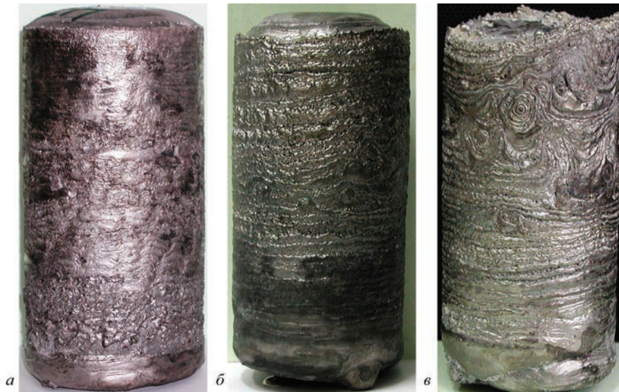
Рис. 2. Зовнішній вигляд титанових зливків, виплавлених ЕШП з використанням поздовжнього постійного магнітного поля різної індукції, Тл: a — 0,16; б — 0,24; в — 0,30
