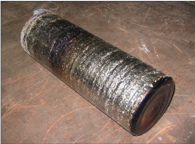
Рис. 2. Зливоч ЕПП діаметром 200 мм алюмініду титану Ti–28Al–7Nb–2Mo–2Cr
