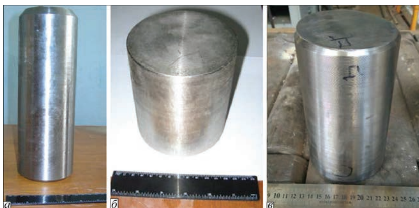
Рис. 3. Зовнішній вигляд зливок титанових сплавів системи \text{Ti-Al-Zr-Si-Mo-Nb-Sn} діаметром 110 мм після механічного оброблення бокової поверхні: а — плавка 812-208; б — плавка 814-208; в — плавка 815-208
