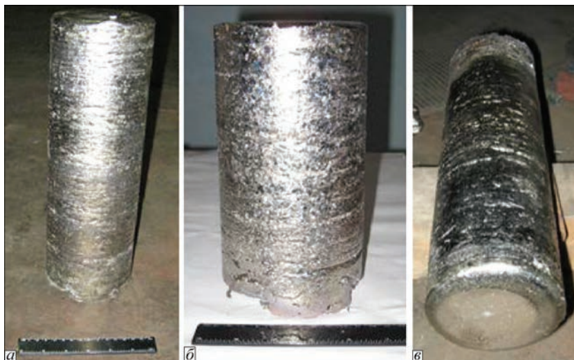
Рис. 2. Зливки титанових сплавів системи \text{Ti-Al-Zr-Si-Mo-Nb-Sn} діаметром 110 мм після ЕПТ: а — плавка 812-208; б — плавка 814-208; в — плавка 815-208
