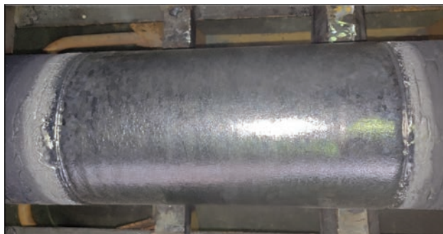
Рис. 6. Зливки ніобію з фрагментом поверхні, оплавленої електронним променем
