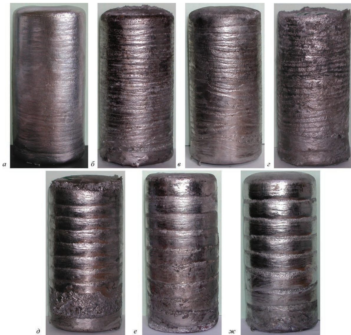
Рис. 3. Зовнішній вигляд титанових зливоків, виплавлених ЕШП з використанням поздовжнього імпульсного магнітного поля: a — B = 0,24 Тл, t_{\text{имп}} = 0,3 с, t_{\text{п}} = 10 с; б — B = 0,24 Тл, t_{\text{имп}} = 1,0 с, t_{\text{п}} = 10 с; в — B = 0,24 Тл, t_{\text{имп}} = 1,5 с, t_{\text{п}} = 10 с; г — B = 0,24 Тл, t_{\text{имп}} = 2,0 с, t_{\text{п}} = 10 с; д — B = 0,22 Тл, t_{\text{имп}} = 11 с, t_{\text{п}} = 21 с; е — B = 0,16 Тл, t_{\text{имп}} = 11 с, t_{\text{п}} = 33 с; ж — B = 0,16 Тл, t_{\text{имп}} = 21 с, t_{\text{п}} = 33 с
