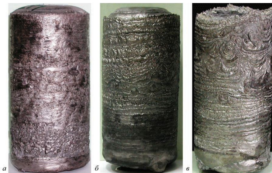
Рис. 2. Зовнішній вигляд титанових зливків, виплавлених ЕШП з використанням поздовжнього постійного магнітного поля різної індукції, Тл: а — 0,16; б — 0,24; в — 0,30
