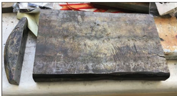
Рис. 1. Напівфабрикат із жароміцного сплаву ЕПП після деформаційної обробки
