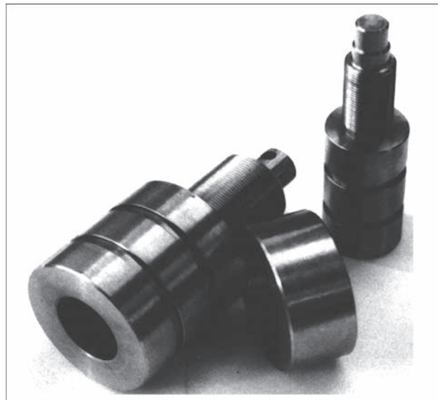
Рис. 6. Деталі з електрошлакового титану після механічної обробки різанням, \times 0,5
