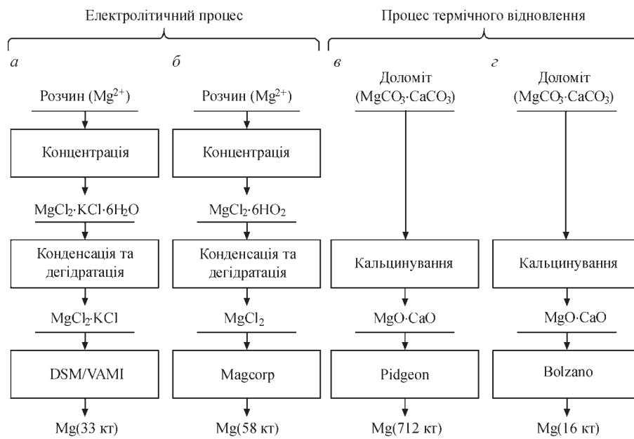
Рис. 1. Блок-схема процесів виробництва первинного металевого магнію: а — DSM/VAMI; б — Magcorp; в — Pidgeon; з — Bolzano
