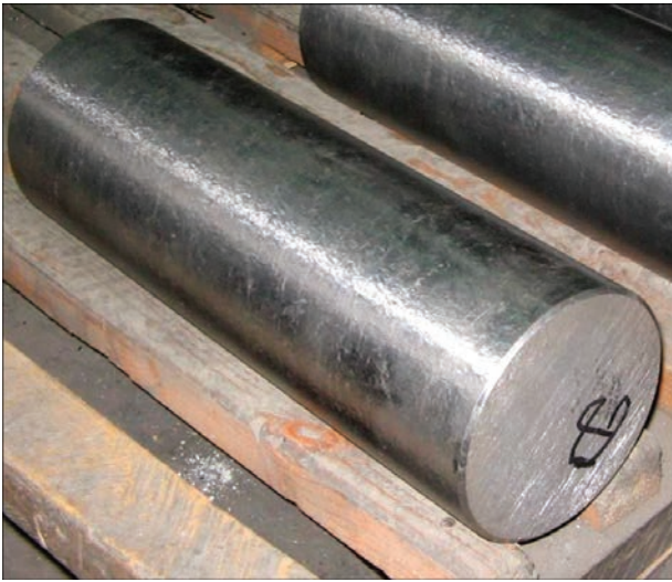
Рис. 9. Механічно оброблений зливкок сплаву титану Ti-6Al-7Nb
