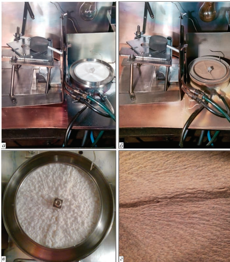
Рис. 2. Загальний вигляд усередині технологічної камери UE-142 з реактором та технологічною ємністю з порошком ПВП перед осадженням срібла (а) та після (б); гранули ПВП у технологічній ємності (в); вид гранул композиту ПВП–Ag після осадження срібла (г)
