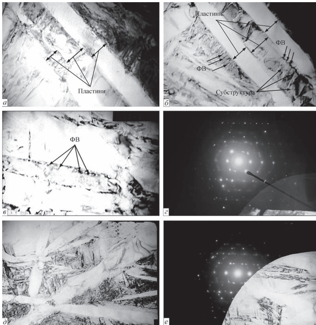
Рис. 2. Тонка структура металу ЗТВ сплаву 2: пластинчаста \alpha' -фаза (а, б, \times 37000 ); формування субструктури (в, \times 50000 ); частинки ФВ у матриці пластин (д, \times 37000 ; е, \times 30000 ); з, е — мікродифракції відповідних структур (е) і (д)
