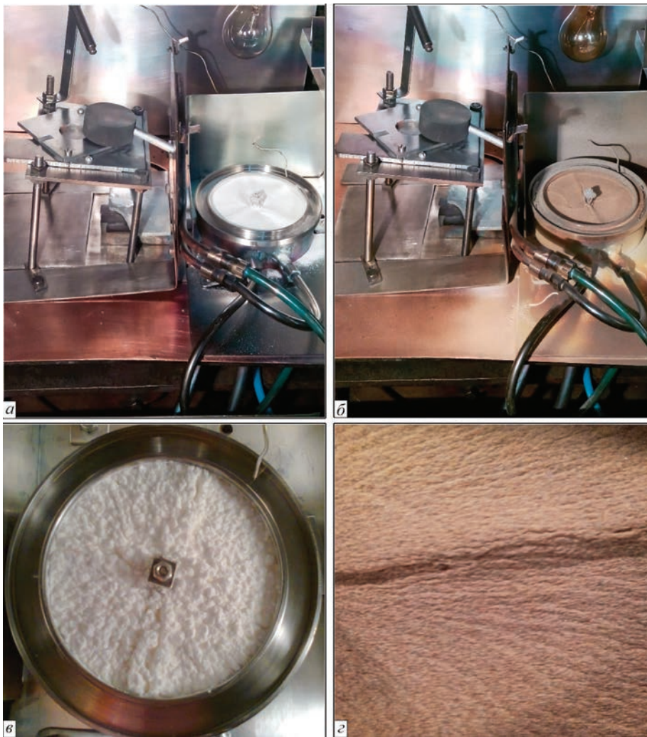
Рис. 2. Загальний вигляд усередині технологічної камери UE-142 з реактором та технологічною ємністю з порошком ПВПІ перед осадженням срібла (а) та після (б); гранули ПВПІ у технологічній ємності (в); вид гранул композиту ПВПІ–Ag після осадження срібла (г)
