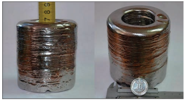
Рис. 8. Загальний вигляд монокристала вольфраму у вигляді порожнистого тіла, що обертається, діаметром 85 мм
