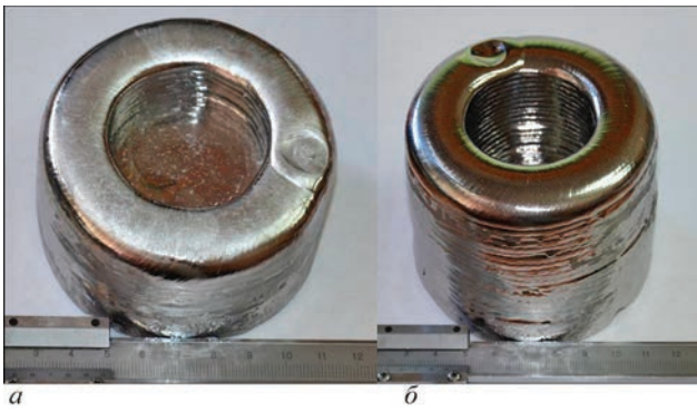
Рис. 7. Монокристал вольфраму: a — після першого етапу наплавлення 6-ти шарів та травлення поверхні; б — після другого етапу нарощування, висота стінки — 35...37 мм
