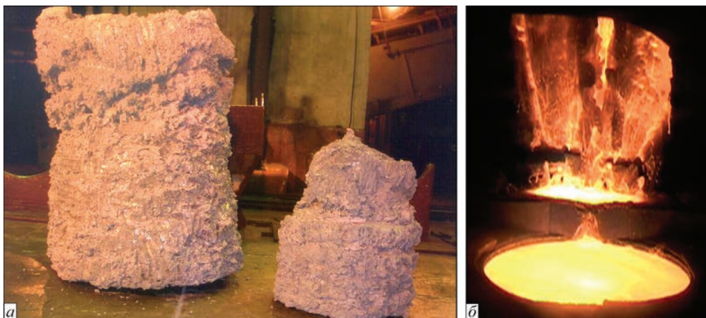
Рис. 3. ЕПП блоків губчастого титану: а — блок губчастого титану масою 4 т в порівнянні з блоком масою 0,7 т; б — ЕПП одержання зливка діаметром 1100 мм з недроблених блоків губчастого титану
