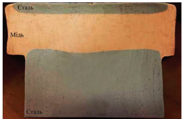
Рис. 3. Зовнішній вигляд сталемідного з'єднання при надмірному оплавленні сталеві частини
