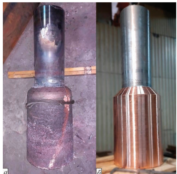
Рис. 7. Чорнова (а) і чистова (б) заготовки подового електрода стрижневого типу
