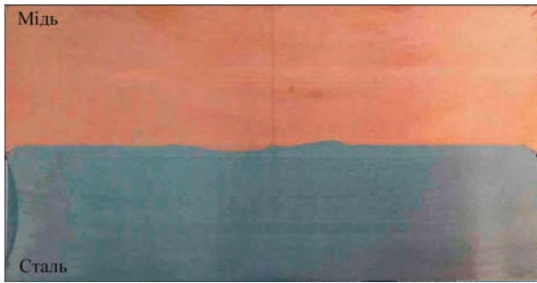
Рис. 4. Зовнішній вигляд сталемідного з'єднання діаметром 320 мм, отриманого електрошлаковим наплавленням міді на сталь
