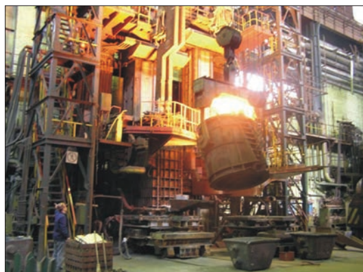
Заливка шлаку в кристалізатор ЕШП на заводі «Дніпрспецсталь»
