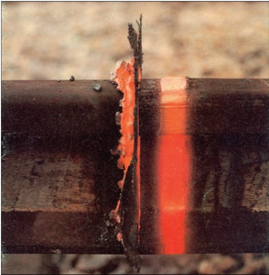
Рис. 6. Вид грата після контактнo-стикового зварювання рейок електрошлаковій тигельній печі є економічно доцільною, особливо для отримання нестандартних литих заготовок високої якості. Підприємства, що спеціалізуються на виготовленні виробів з нержавіючої сталі, можуть використовувати спосіб ЕШТП для переробки стружки, що утворюється, з поверненням отриманого металу в основне виробництво.
