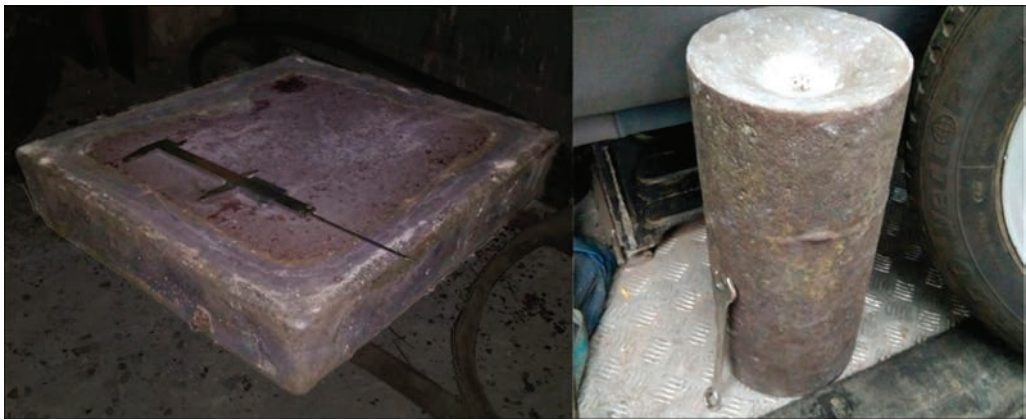
Рис. 4. Плоска заготовка та круглий зливок, отримані з лому нержавіючої сталі
