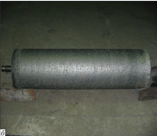
Рис. 7. Готові зливки діаметром 400 мм із жароміцних сплавів: а — ХН60ВТ; б — ХН38ВТ
