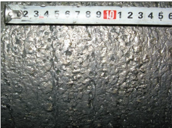
Рис. 8. Якість литої поверхні зливка діаметром 400 мм жароміцного сплаву ХН60ВТ
