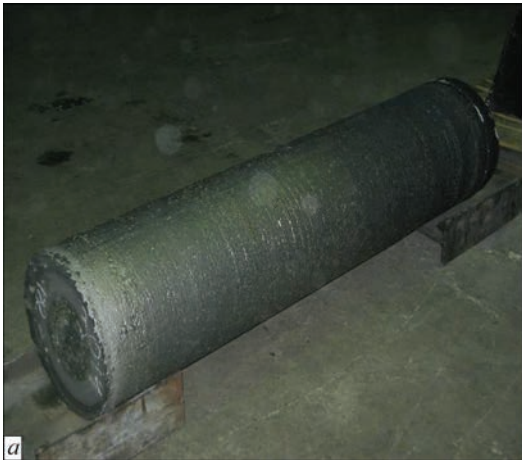
Рис. 7. Готові зливки діаметром 400 мм із жароміцних сплавів: а — ХН60ВТ; б — ХН38ВТ
