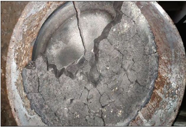
Рис. 2. Зовнішній вигляд шлаку та феросплаву у виливниці близько 16 хв і ще протягом 4 хв шлакову ванну витримували під струмом. По завершенні процесу продукти плавки злили у сталеву виливницю (рис. 2). При цьому в плавильному тиглі не залишилося жодних залишків металу чи шлаку. Загальна маса продуктів плавки склала 23,05 кг, з них 7,15 кг ферованадію та 15,9 кг шлаку (2,22 кг шлаку на кілограм металу). Втрати з випаровуванням склали 0,55 кг. Кількість отриманого ферованадію становить 84,3 % від сумарної розрахункової кількості ванадію і заліза шихти. При цьому питома витрата електроенергії становить 1,958 кВт·год/кг або 14 кВт·год на один експеримент.
