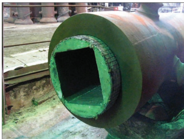
Рис. 6. Теплоізолююча вставка для формування головної частини хвостовика для затискання електрода в електродотримачі
