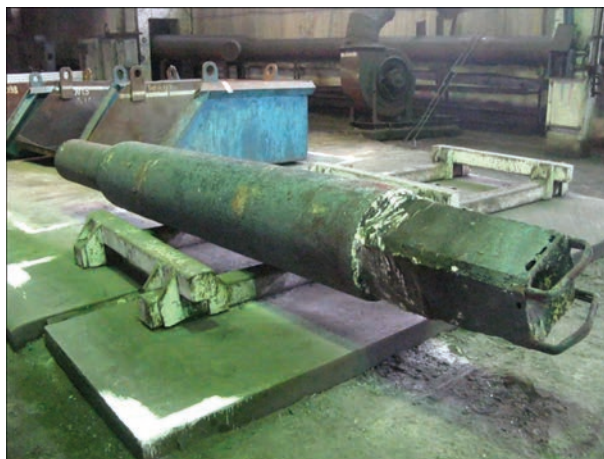
Рис. 9. Литий електрод змінного перерізу діаметрами 560/400 мм для ЕШП, кристалізатор діаметром 800 мм
