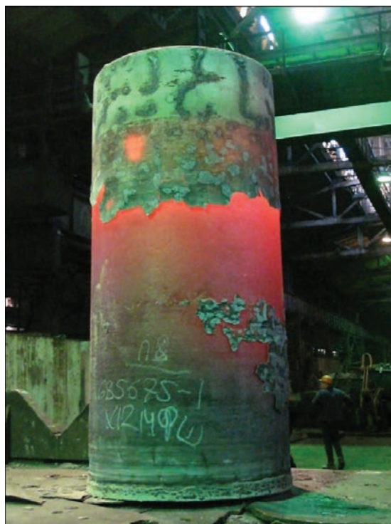
Рис. 10. Злиток Х12МФ-Ш діаметром 800 мм та масою шість тонн з литого електрода змінного перерізу
