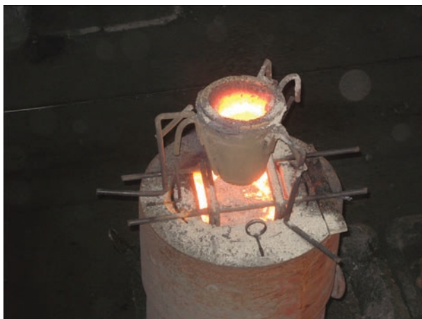
Рис. 5. Зовнішній вигляд головної частини виливниці з проміжною ємністю після виливки електрода для ЕШП
