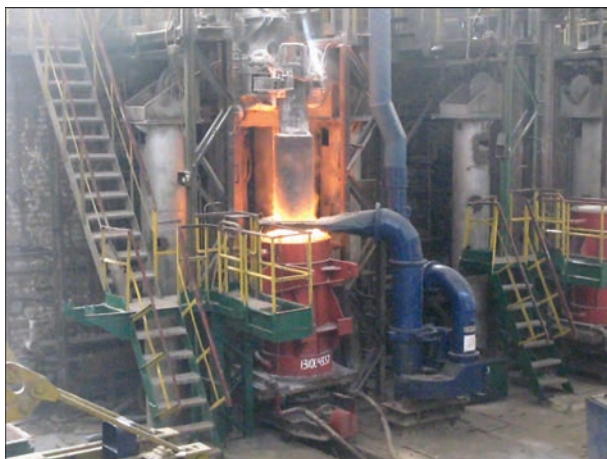
Рис. 7. Електрошлаковий переплав електрода змінного перерізу на печі ЕШП ОКБ 1065, кристалізатор діаметром 800 мм
