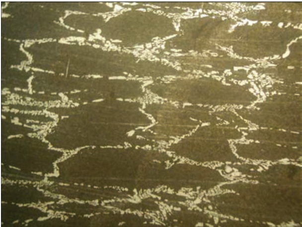
Рис. 12. Карбідна неоднорідність у зразку від поковки діаметром 520 мм сталі марки Х12МФ-Ш, ×100
