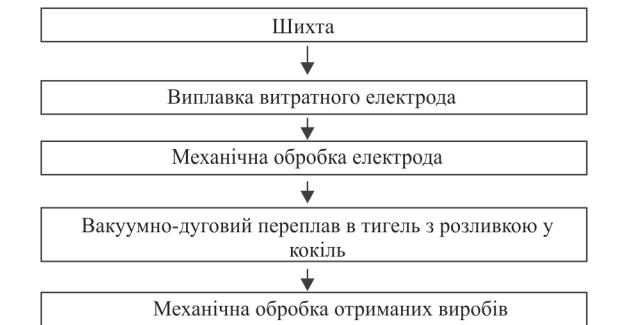
Рис. 1. Схема технологічного процесу отримання виробів з алюмініду титану
