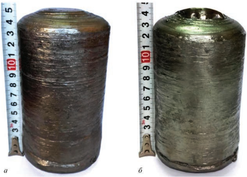
Рис. 2. Зливки титану BT1-0, виплавлені при тиску 25 (а) і 160 кПа (б)
