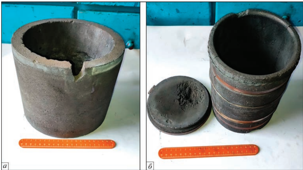
Рис. 7. Зовнішній вигляд графітових тигля (а) і кокілю (б) для вакуумно-дугового переплаву
