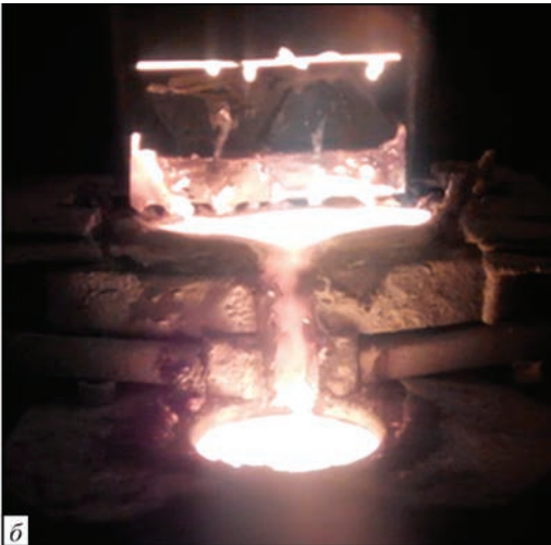
Рис. 3. Шихтова заготовка (а) і процес електронно-променевої плавки (б) зливка алюмініду титану Ti–28Al–7Nb–2Mo
