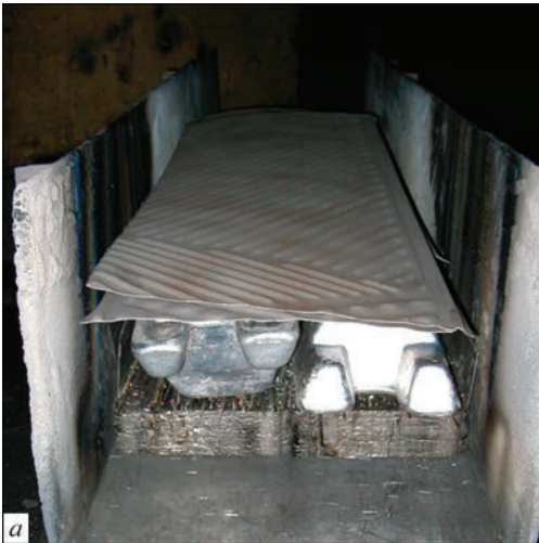
Рис. 3. Шихтова заготовка (а) і процес електронно-променевої плавки (б) зливка алюмініду титану Ti–28Al–7Nb–2Mo
