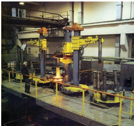
Лабораторний комплекс УШ-149 для виплавки зливків із змінних електродів, що витрачаються
