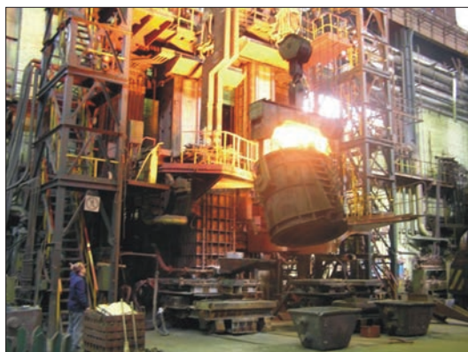
Заливка шлаку в кристалізатор ЕШП на заводі «Дніпросталь»
