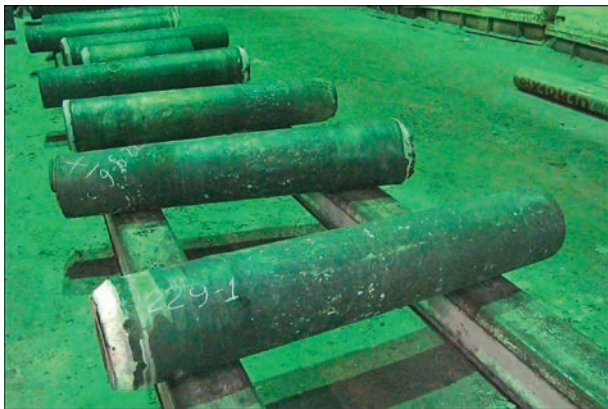
Рис. 2. Зливки ЕШП діаметром 300 мм зі сталі В60-ШД
