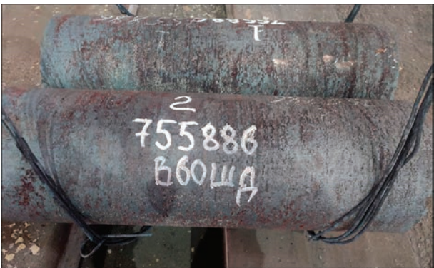
Рис. 3. Зливки ВДП діаметром 370 мм зі сталі В60-ШД
