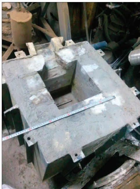
Рис. 2. Тигель ємністю 120 кг для проведення ЕШТП стружки стартовий період при наведенні шлакової ванни стружка не подавалася для плавки. У цей період сплавляється приблизно 25...30 мас. % металевого електрода. Наприклад, у плавці 7 стружку почали подавати у піч, коли сплавилось 18,5 кг металевого електрода з вихідних 59,6 кг. Потім при плавці 41,1 кг електрода, що залишився, було переплавлено 60,2 кг стружки або близько 60 % від загальної кількості металу, що переплавлявся в період подачі стружки. Тобто можна збільшити ступінь використання стружки для переробки застосовуючи такі технологічні прийоми, як рідкий старт, або спочатку використовувати для наведення шлакової ванни невитратний електрод з подальшою його заміною на металевий, який переплавлятиметься.
