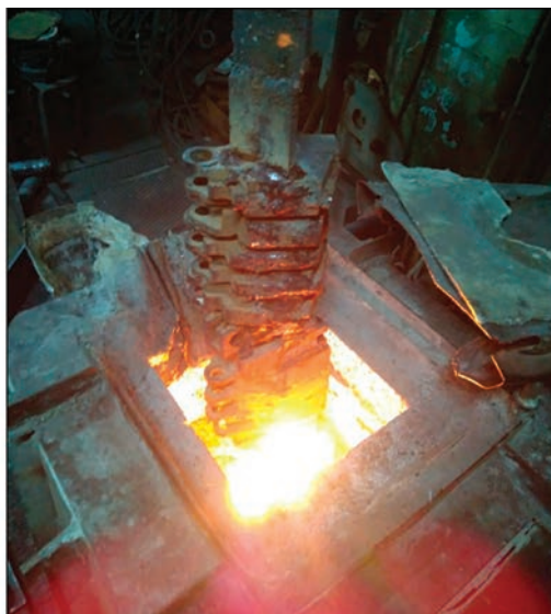
Рис. 3. Зовнішній вигляд витратних електродів з нержавіючої сталі для проведення електрошлакової тигельної плавки
