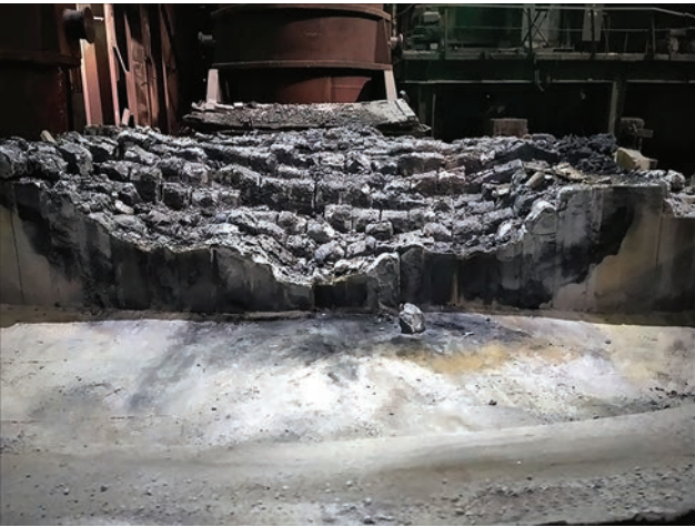
Рис. 2. Вид футерівки фурменної зони відпрацьованого днища кампанії 480 ТОВ «РЕФРАМАТ». Стійкість футерівки 88 плавов
