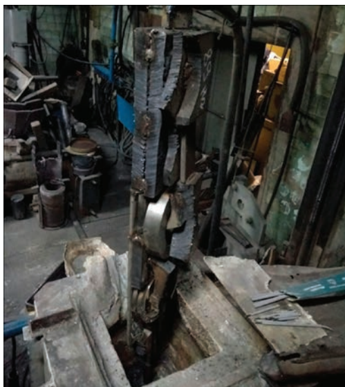
Рис. 3. Зовнішній вигляд витратних електродів з нержавіючої сталі для проведення електрошлакової тигельної плавки
