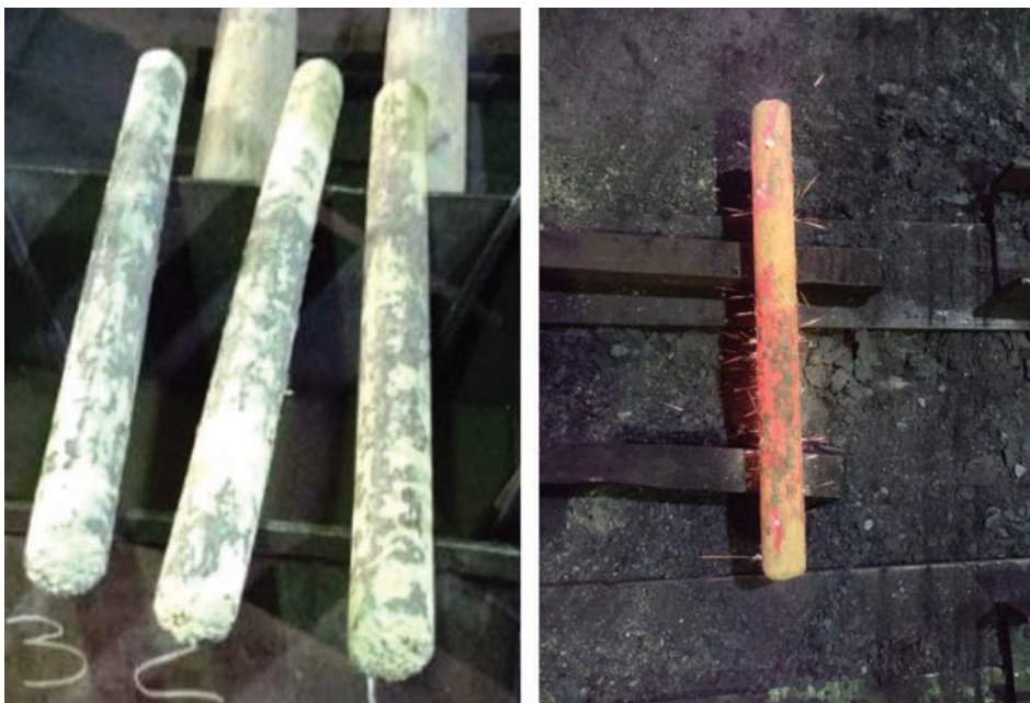
Рис. 7. Зовнішній вигляд поковок діаметром 59 мм сплаву 60Zr20Ti20Nb
