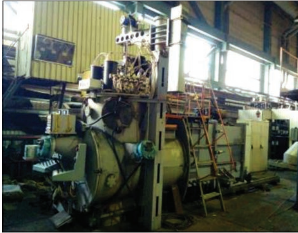
Рис. 3. Зовнішній вигляд модернізованої електроно-променевої установки УЕ-208М
