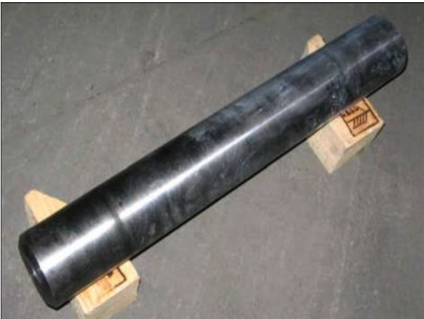
Рис. 6. Зовнішній вигляд механічно обробленого зливка діаметром 110 мм сплаву 60Zr–20Ti–20Nb
