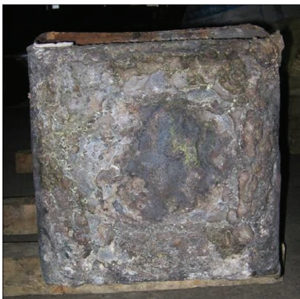
Рис. 2. Зовнішній вигляд головної частини вихідної шихтової заготовки
