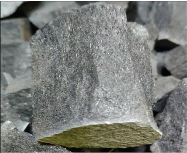
Рис. 3. Загальний вигляд шару шлаку у розрізі (знизу межа шлак–метал)
