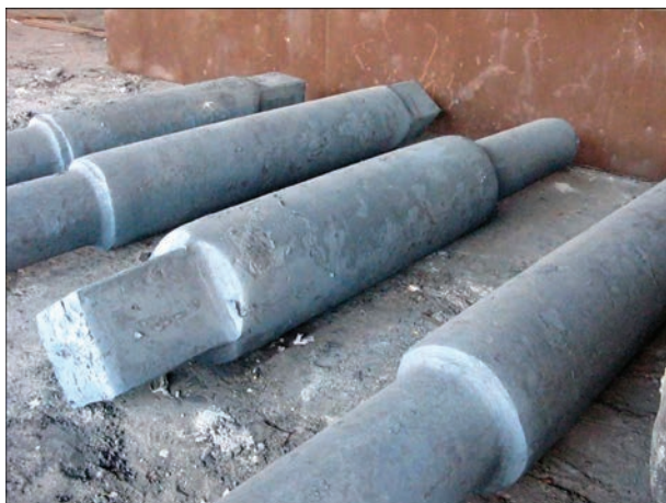
Рис. 3. Ковані експериментальні електроди змінного перерізу із сталі Х12МФ-Ш для злитка діаметром 800 мм
