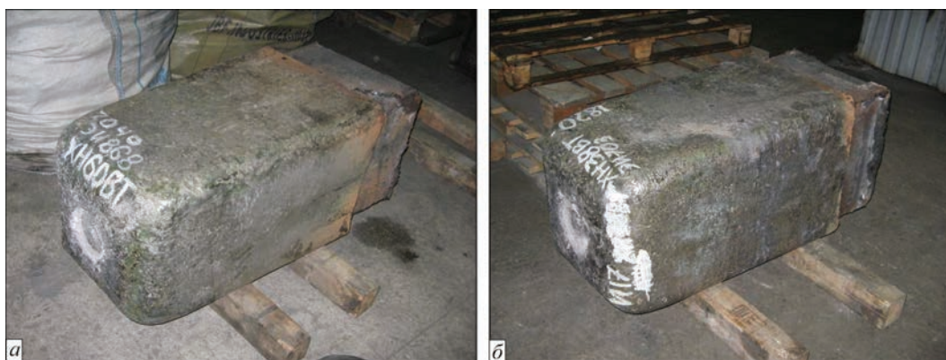
Рис. 1. Шихтові заготовки: а — ХН60ВТ; б — ХН38ВТ
