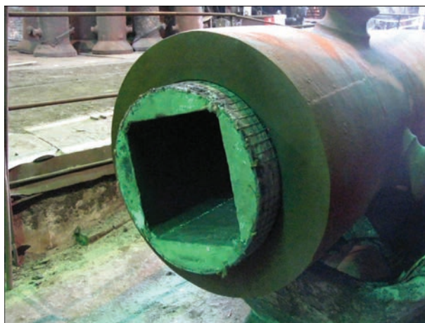
Рис. 6. Теплоізолююча вставка для формування головної частини хвостовика для затискання електрода в електродотримачі
