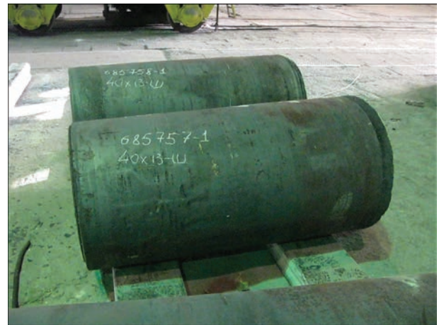
Рис. 11. Зливки ЕШП сталі 40Х13-Ш з литого електрода змінного перерізу
