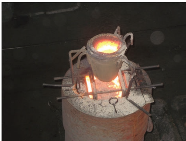
Рис. 5. Зовнішній вигляд головної частини виливниці з проміжною ємністю після виливки електрода для ЕШП
