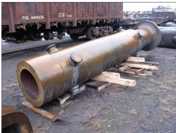
Рис. 4. Виливниця для виливки електрода змінного перерізу діаметрами 560/400 мм
