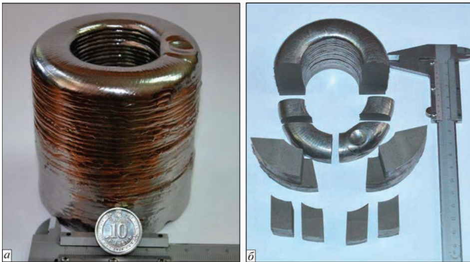
Рис. 7. Кристал вольфраму, вирощений у вигляді циліндричного порожнистого тіла діаметром 85 та 68 мм (а), і його відокремлена верхня частина, розрізана на дрібні зразки (б)
