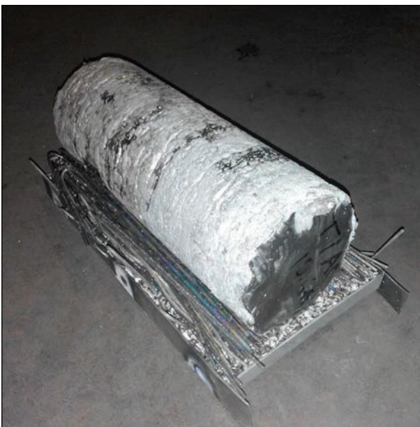
Рис. 2. Шихтова заготовка для одержання сплаву ортоалюмініду титану Ti-39Nb-16Al-2,6Mo-1,4Zr
