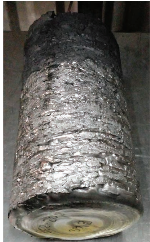
Рис. 4. Зливков діаметром 110 мм сплаву ортоалюмініду титану Ti-39Nb-16Al-2,6Mo-1,4Zr
