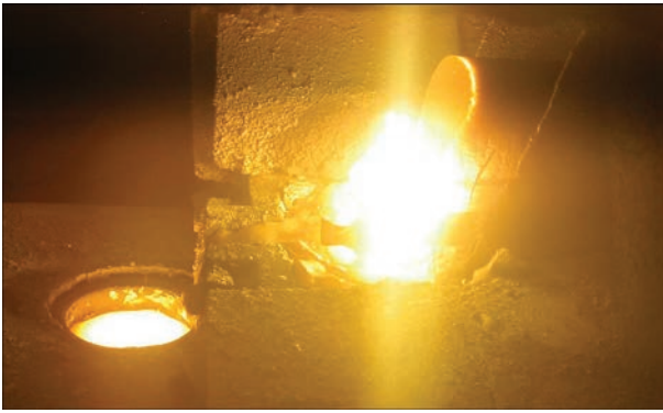
Рис. 3. Процес плавки зливка діаметром 110 мм сплаву ортоалюмініду титану Ti-39Nb-16Al-2,6Mo-1,4Zr
